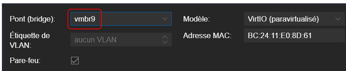
Votre machine pfSENSE possède maintenant **3 cartes réseau** : une pour l'interface **WAN**, une pour l'interface **LAN** et la nouvelle sera affectée à la **DMZ** (attention, les numéros des « vmbr » peuvent changer en fonction de votre configuration) :
