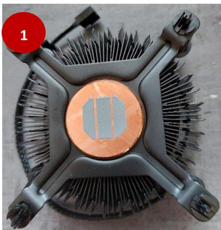
Le dessous du dissipateur © Intel comporte un support cuivré avec de la pate thermique pour améliorer la dissipation de chaleur. Le dissipateur présente 4 points d'attache sur la carte mère et un câble d'alimentation pour le ventilateur.
