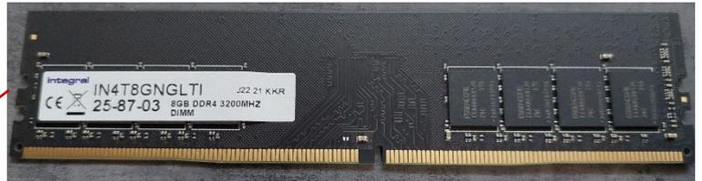
La mémoire vive doit être connectée au slot DIMM présent sur la carte mère (utiliser le 1<sup>er</sup> slot disponible). Attention, il est important de respecter le sens : un « détrompeur » est présent sur la barrette de mémoire vive. Ce « détrompeur » est reconnaissable à l'encoche présente sur le composant et sur le slot DIMM de la carte mère.
