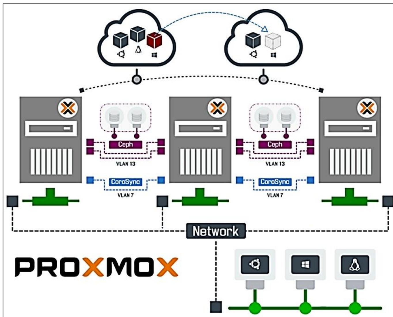
Pour profiter des performances et de l'hyper-convergence, nous allons utiliser Ceph sur les 3 nœuds de notre cluster Proxmox. Lors de la mise en place de Ceph, nous allons distinguer :
